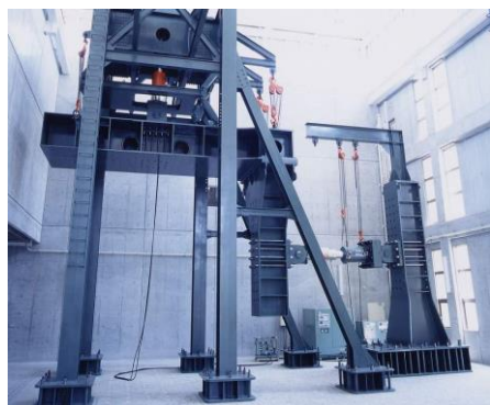
写真 1. 建研式逆対称載荷装置
