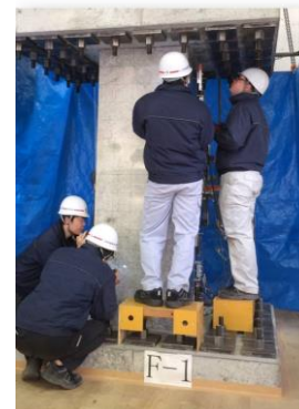
写真 3. 実大梁部材の実験 (建築研究所・京都大学共研)
